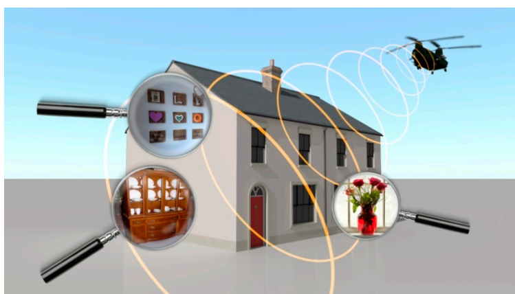
Figuur 1: De helikopter rechts boven in beeld veroorzaakt geluidsgolven. Deze komen onder andere terecht op het dak en de gevel van het huis. Deze kunnen daardoor gaan trillen en daarbij geluid veroorzaken. Ze kunnen ook voorwerpen in huis, zoals servies in de kast of vazen op vensterbanken laten meetrillen, waar ook weer geluid door veroorzaakt kan worden.
