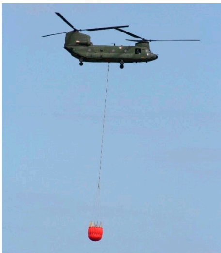
Figuur 1: Chinook helikopter met externe last onder de helikopter
